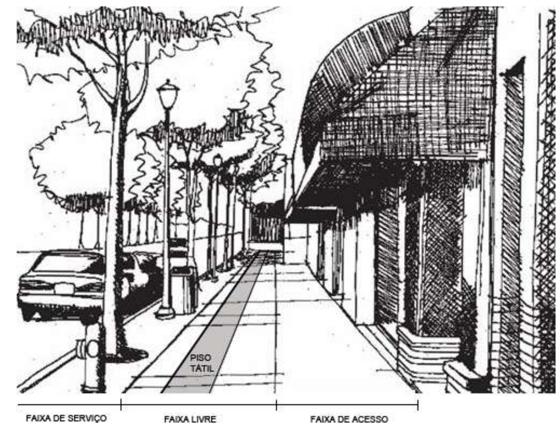
Figura 9.3 – Modelo inclusivo e acessível de calçada
