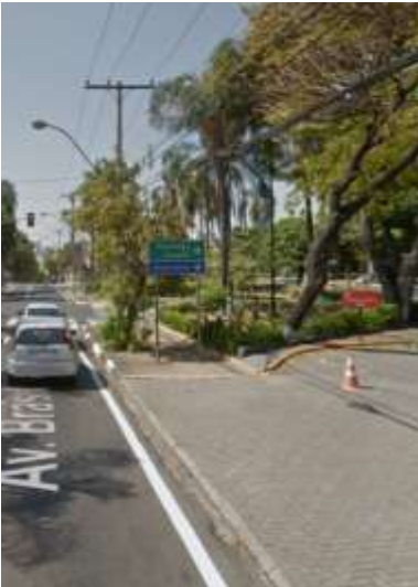
Av. Brasil (Sinalização de trânsito obstruindo a calçada) Fonte: Google Street View (2015)
