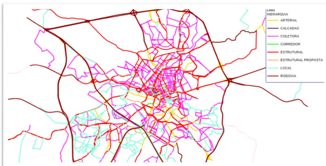
Figura 22 – Rede Viária Hierarquizada Fonte: EMDEC
