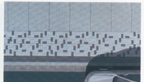
↑ Simulação de calçada no padrão III, com bloco intertravado e concreto
